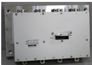
Интегральный силовой модуль ВИСМ2417Ф41АЖ-4Д1Н «полумост»
