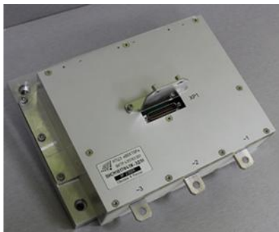
Интегральный силовой модуль ВИСМ1817Ф41АЖ-ЗД1Н «полумост»
