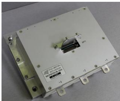
Интегральный силовой модуль ВИСМ1812Ф41АЖ-ЗД1Н «полумост»
