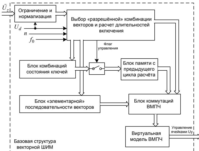
Рис. 3.3. Схема структурная модулятора в режиме векторного формирования ШИМ
