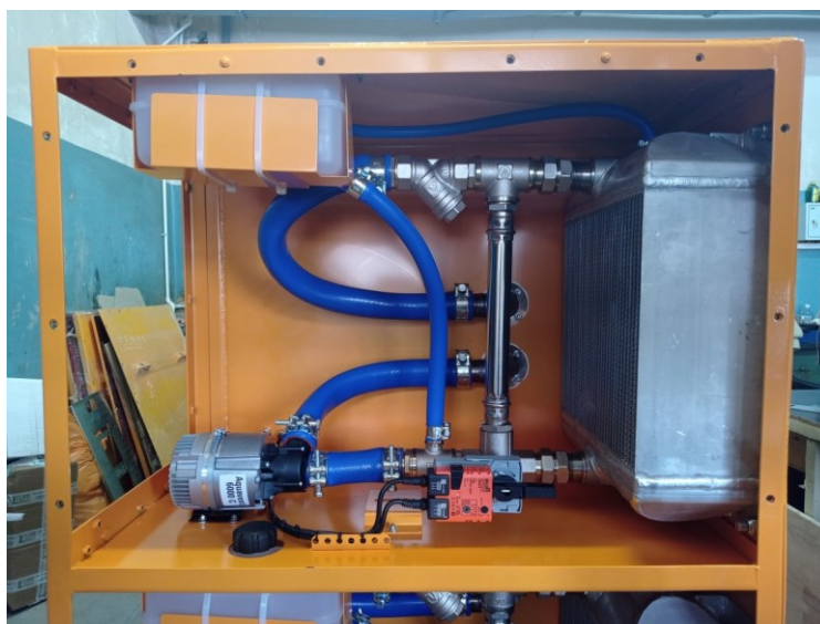
Рис. 3. Отсек элементов жидкостной системы охлаждения
