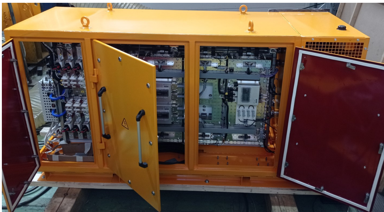
Рис. 2. Расположение блоков управления и защиты в ШПСУ
